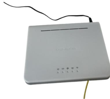
**Schritt 2 :** Ziehen Sie das Glasfaserkabel durch Zusammendrücken des blauen Steckverbinders aus dem Anschluss auf der Unterseite Ihres Modems. Vorsicht: Achten Sie darauf, den Stecker nicht zu beschädigen – er kann etwas schwierig zu entfernen sein.
