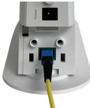
**ESchritt 3 :** Setzen Sie die Abdeckung wieder auf und stellen Sie sicher, dass der kleine grüne Stecker in der Wand-Glasfasersteckdose immer noch auf Position 1 eingesteckt ist.
