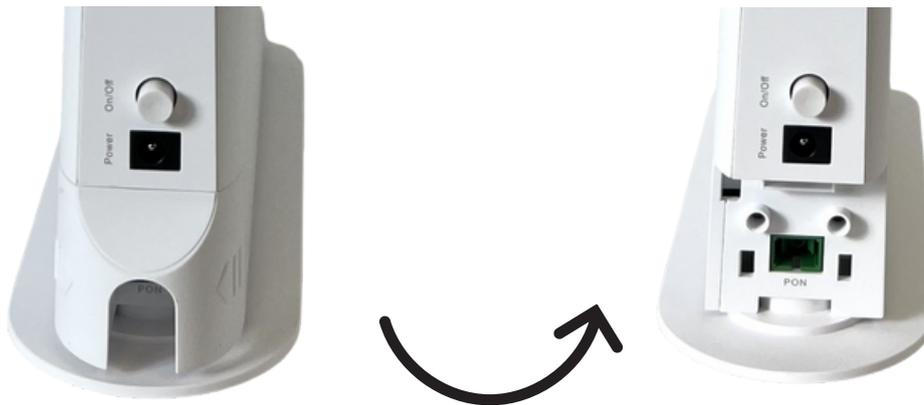
**Schritt 2 :** Schliessen Sie den grossen blauen Stecker des Glasfaserkabels, das Sie zuvor vom bisherigen Modem entfernt hatten, mit der Kerbe nach unten am PON-Steckplatz des neuen Modems an.
