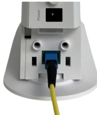
**Étape 3 :** remettez le capot et contrôlez que le petit connecteur vert est encore connecté sur la position 1 de la prise optique murale.
