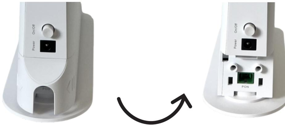
**Étape 2 :** Branchez le grand connecteur bleu du câble optique, précédemment débranché de l'ancien modem, sur le port PON du nouveau modem avec l'encoche vers le bas.
